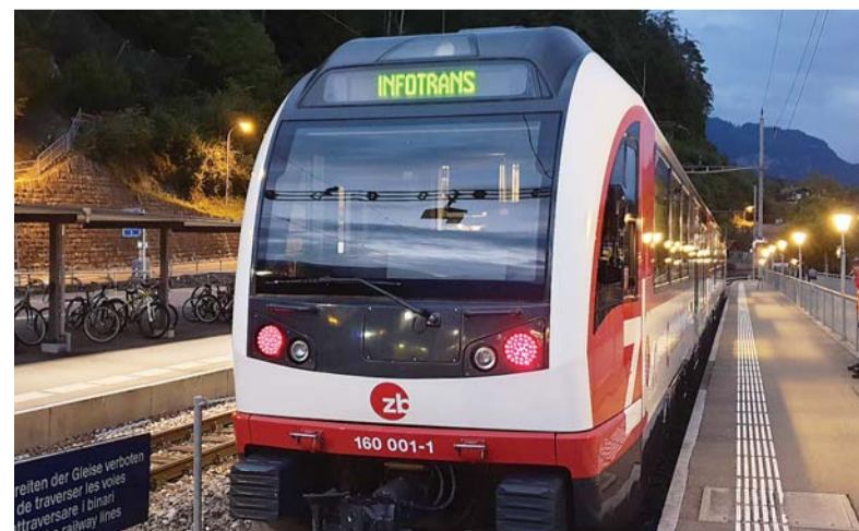
Пассажирский поезд FINK (Zentralbahn AG, Швейцария) с автономной системой контроля состояния пути (АТМ).
